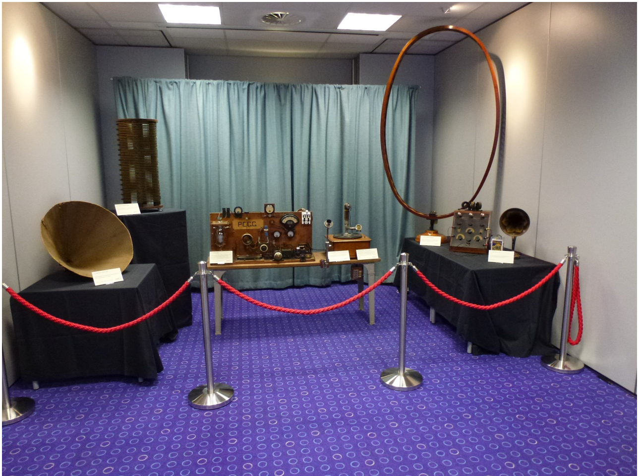
De Idzerda zender in het bezit van Beeld & Geluid, met grammofoon, microfoon, antenne verlengspoel, kartonnen "toeter" en een reusachtige raamantenne
